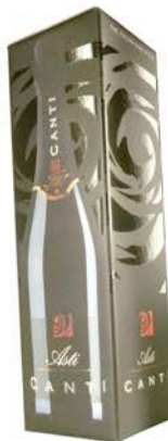
Realizzata da Cartotecnica Olimpia, la confezione di Asti Canti, stampata in offset a 5 colori, è in cartoncino Kraft CKB da 215 g accoppiato a microonda TBM35E. Plastificatura opaca con vernice serigrafica UV lucida e stampa a caldo oro.
